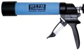
Strapazierfähige Handpress-Pistole aus hochschlagfestem Kunststoff, sehr leicht. Mit Schiebehülsen-Verschluss, glatter Schubstange und Schiebehülse für 290/300/310 ml Kartuschen. Entspannung erfolgt automatisch.
