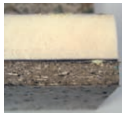
Dämmstoff mit Spanplatte
