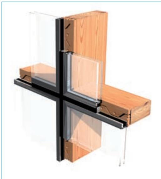
Aufbau eines HGV-Elementes
