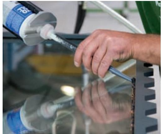
Einbringen des 2K Silicons für Holz-Glas-Verbundelemente
