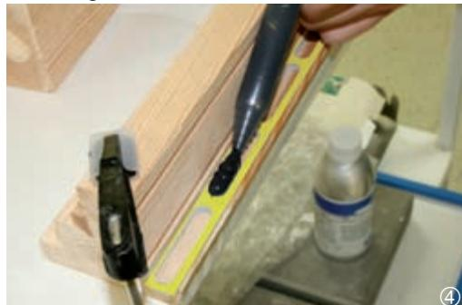
5. Überflüssigen Klebstoff mit Spachtel entfernen. Ein Zusammendrücken des Bandes beim Abziehen ist zu vermeiden, damit die erforderliche Klebstoffhöhe in den Ausstanzungen nicht unterschritten wird.
