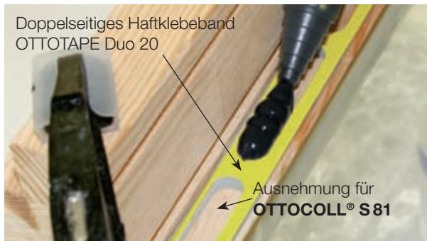
Ablauf einer Verarbeitung mit dem **OTTOTAPE Duo 20** und **OTTOCOLL® S81** am Beispiel eines Holzfensterprofils.
