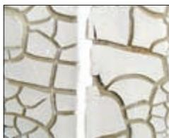
Nach der vollständigen Trocknung der Paste (ca. 12 Std.) den verbleibenden Feststoff mit einem Besen abkehren oder absaugen.
