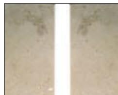
Nach der Reinigung dürfen keine dunklen Flecken mehr sichtbar sein. Tief liegende Verschmutzungen durch zweiten oder dritten Auftrag entfernen.
