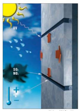
Neben UV-Strahlen, Niederschlägen, chemischen Emissionen und Temperaturschwankungen ist der Dichtstoff an der Fassade unterschiedlichen Kräften ausgesetzt, die er ohne Veränderung überstehen muss.
